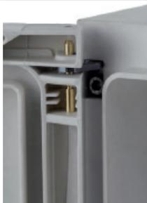
Le cerniere della porta, realizzate in acciaio inossidabile e ottone nichelato, sono state posizionate lontano dagli spigoli per evitare eventuali rotture accidentali in seguito a cadute o urti.
