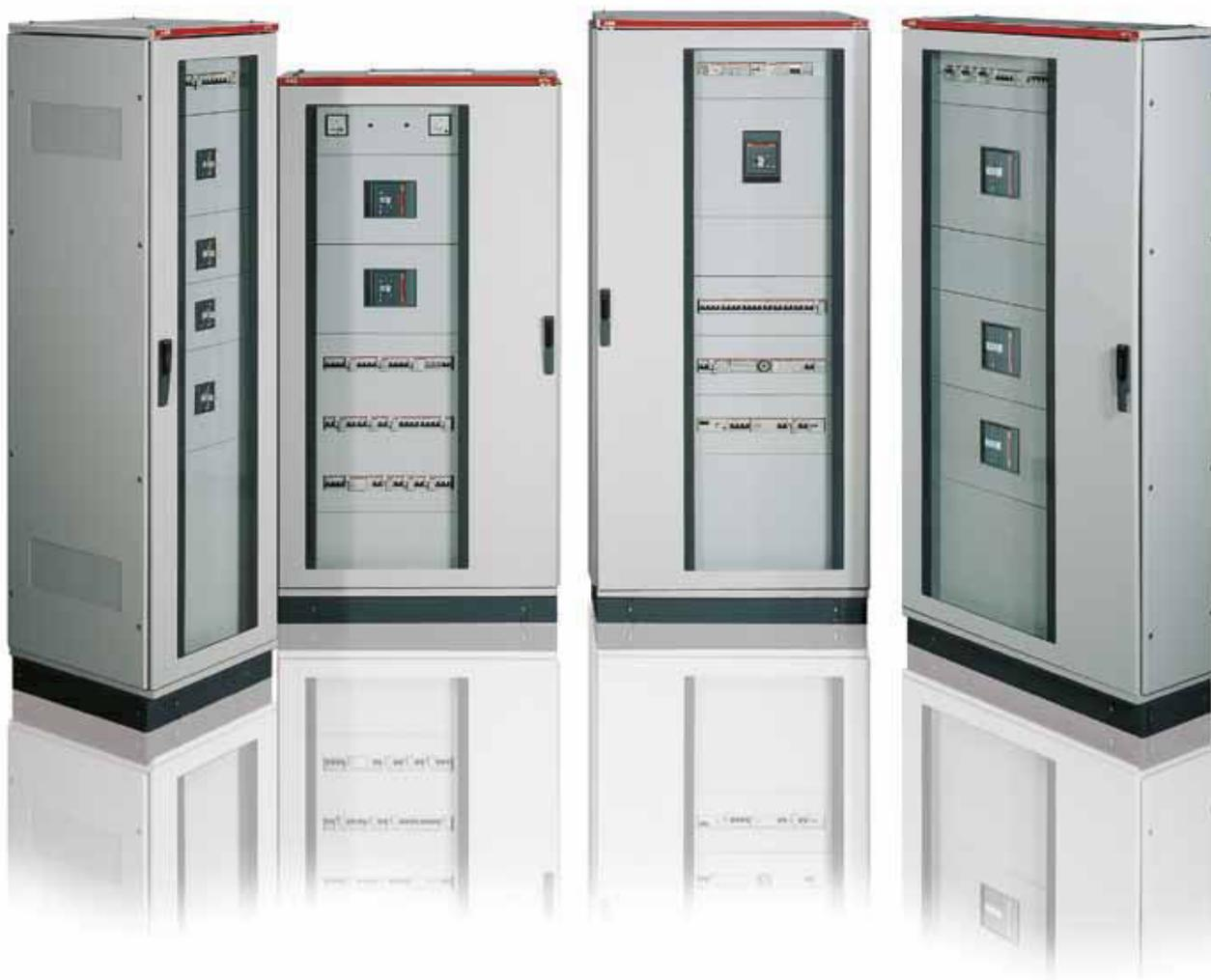
Le porte dei quadri ArTu K sono in lamiera spessore 15/10 cieche o con cristallo di sicurezza spessore 4mm, sono dotate di guarnizione che garantisce il grado di protezione IP65.
