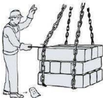
IMBRICATORE CON GUANTONI, SCARPE DI SICUREZZA, CASCO, GIUBBOTTO AD ALTA VISIBILITÀ, UNCINO PER AFFERRARE CATENE, FUNI, CORDE, ...
