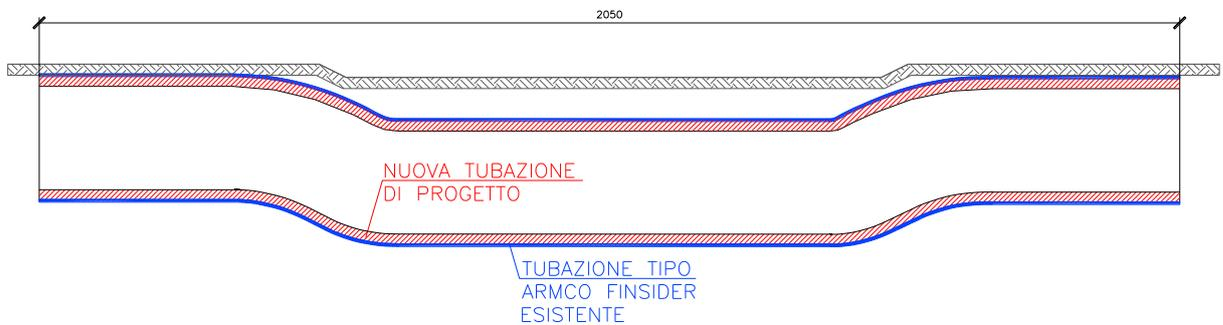
Figura 5: Sezione longitudinale manufatto. In rosso nuovo tubo.
