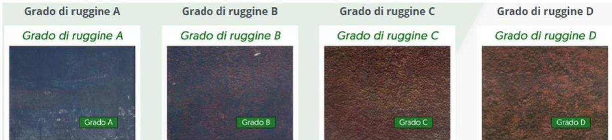
**GRADO DI PREPARAZIONE** → Si considera Raschiatura e spazzolatura **Grado D St2**
