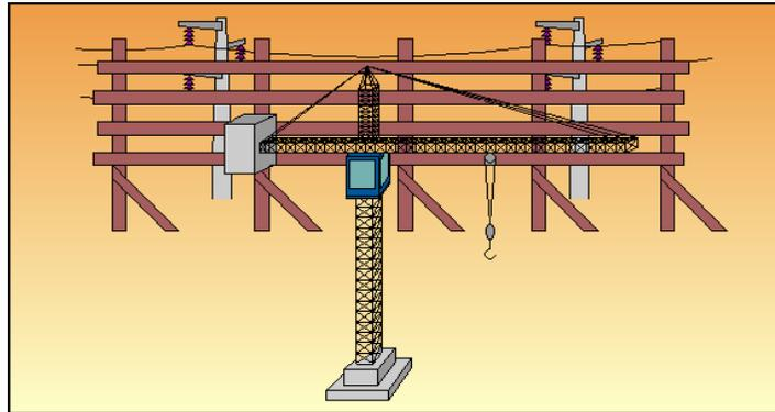
**b) posizionare ostacoli rigidi che impediscano l'avvicinamento alle parti attive. VALIDO ANCHE PER ESCAVATORI, AUTOGRU', AUTOPOMPE PER IL CALCESTRUZZO e altri mezzi d'opera;**
