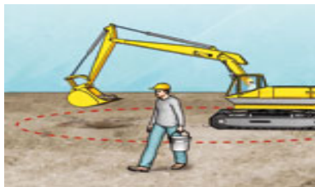
NON SOSTARE NEL RAGGIO D'AZIONE MEZZI
