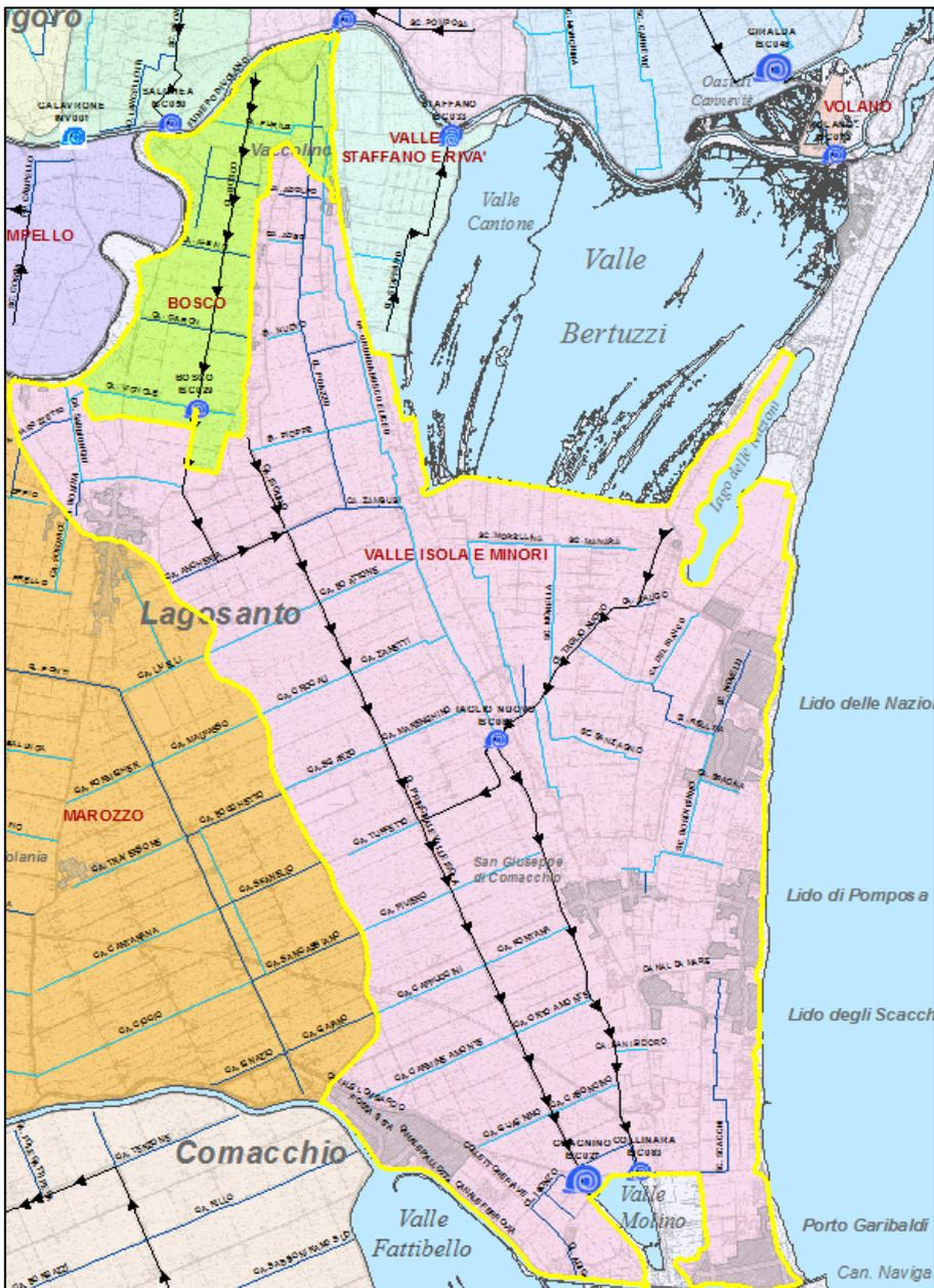
E' un'area depressa molto lontana dall'Impianto Idrovoro Guagnino che perciò necessita di un presollevamento, mediante l'Impianto Idrovoro Bosco (2,1 m<sup>3</sup>/s).
