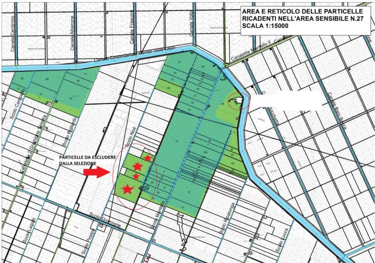
Esempio di un'elaborazione cartografica di un'area sensibile con apportate le correzioni dei geometri di reparto. Le particelle evidenziate con la stella rossa sono state escluse dalla selezione.
