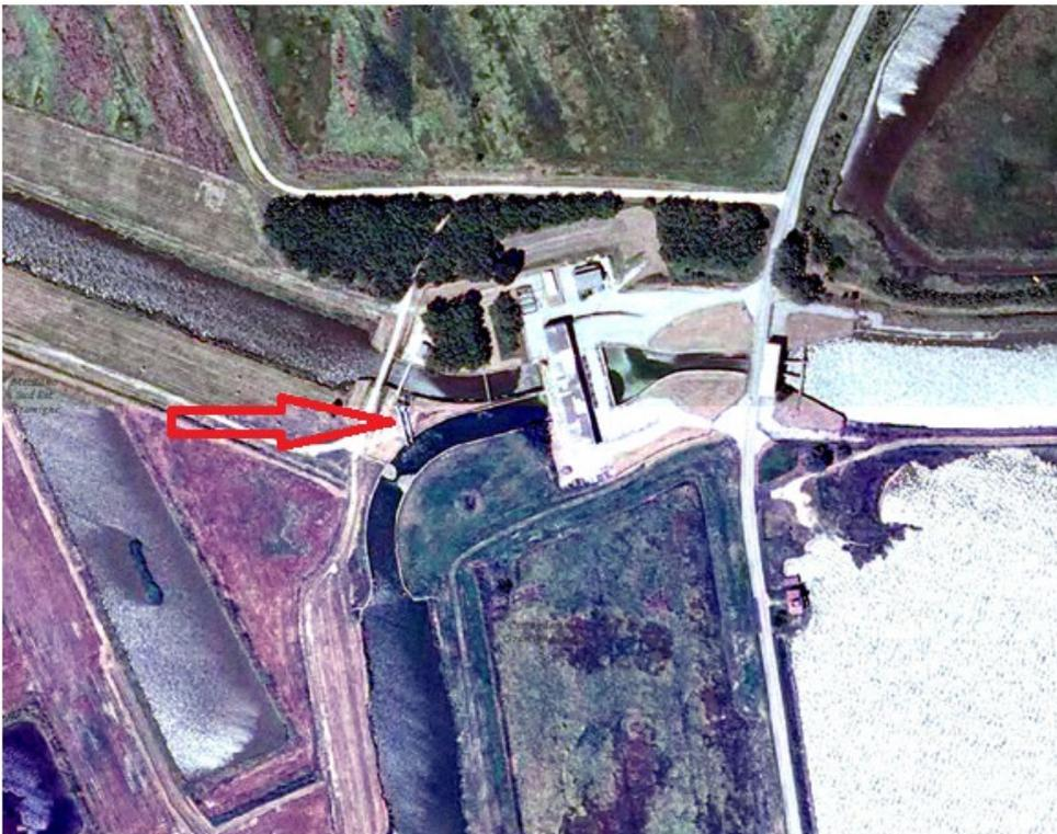
Impianto Idrovoro Fosse in una ortofoto del 2011. La freccia evidenzia il piccolo e breve canale di collegamento che consente il passaggio dalle acque basse del collettore Fosse (a nord) alle acque alte del canale Circondariale Gramigne Fosse. Il passaggio da acque basse ad alte è effettuato con il sollevamento da parte del piccolo Impianto Idrovoro Fosse Esterno.
