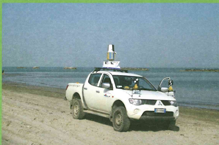
Rilevamento delle barriere litoranee artificiali e loro evoluzione con modelli tridimensionali costruiti con laser-scanner. Si noti la posizione dei traguardi per la georeferenziazione dei dati rilevati
