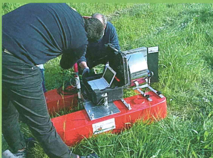
Rilevamento del fondale dei canali di bonifica con il natante drone dotato di sonar e GPS, sviluppato dal Consorzio di Bonifica in collaborazione con la ditta SIZG di Ancona
