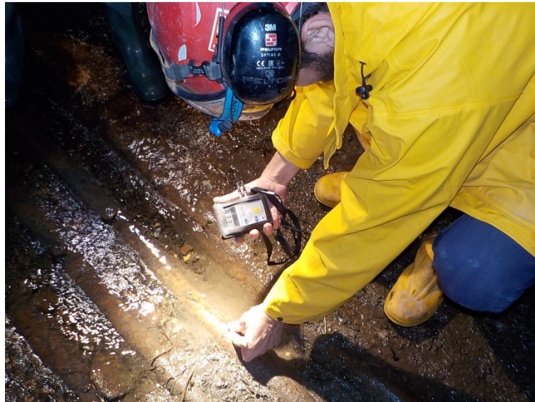
Figura 12: rilievo dello spessore di elementi metallici utilizzando uno spessimetro ultrasonico
