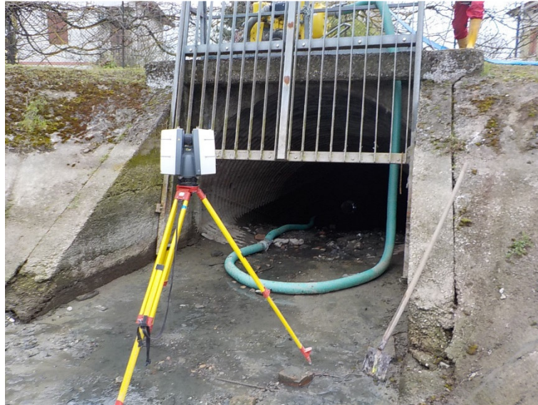
Figura 9: rilievo laser scanning - Tubo Finsider in località Corporeno
