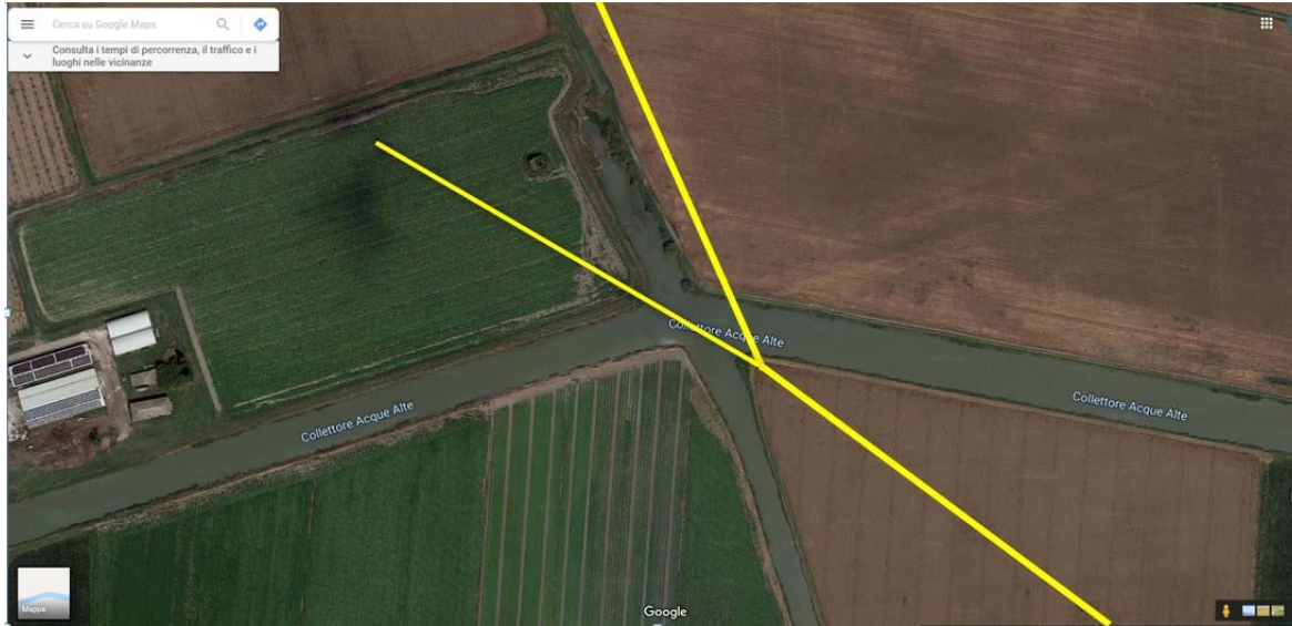
Figura 16. Individuazione del cavo protetto dell'ENEL interferente in corrispondenza della sezione 48 e nell'area di accumulo - planimetria.
