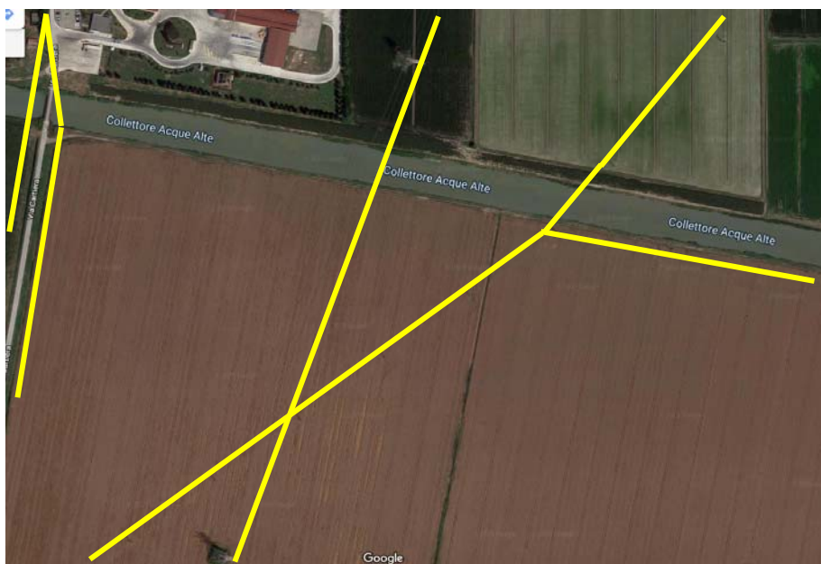
Figura 13. Individuazione del cavo protetto dell'ENEL interferente tra le sezioni 51F e 53 - planimetria.
