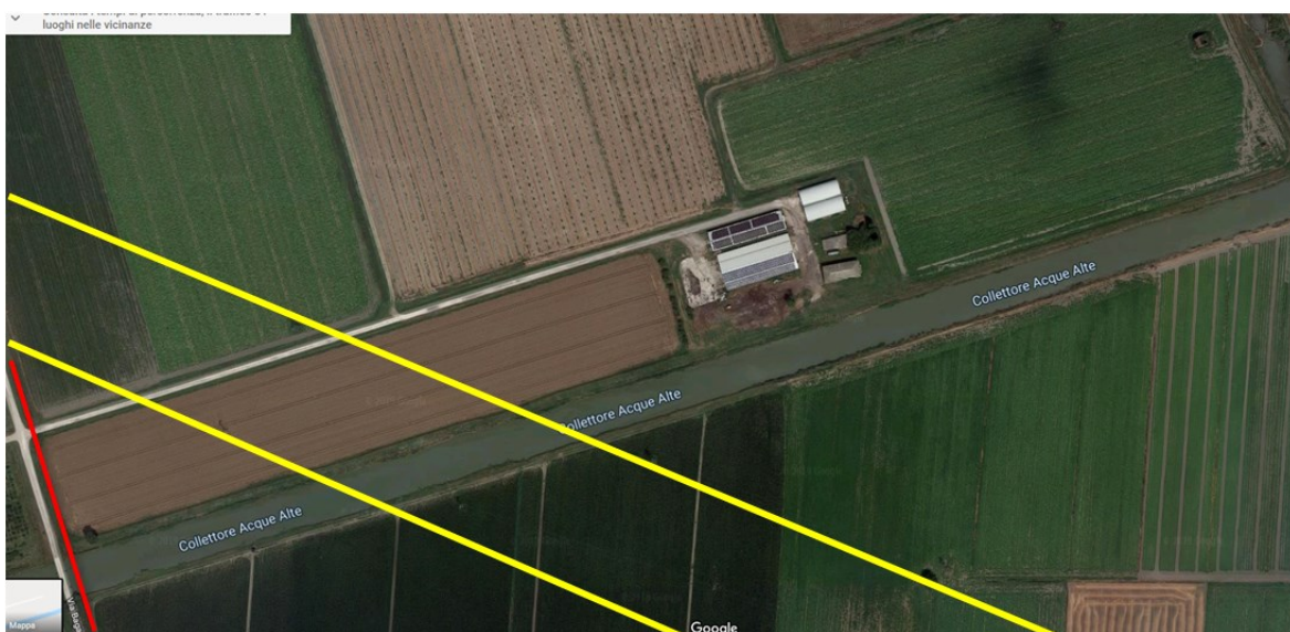
Figura 19. Individuazione del cavo protetto dell'ENEL (in giallo) e Linea telefonica a ridosso del ponte (in rosso) - interferente tra le sezioni 45 e 46 - planimetria.
