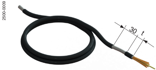
Fig. 25 Spelare il cavo CEM di 30 cm prima del collegamento alla morsettiera. La misura "t" corrisponde alla distanza approssimativa della fascetta di fissaggio dal morsetto.
