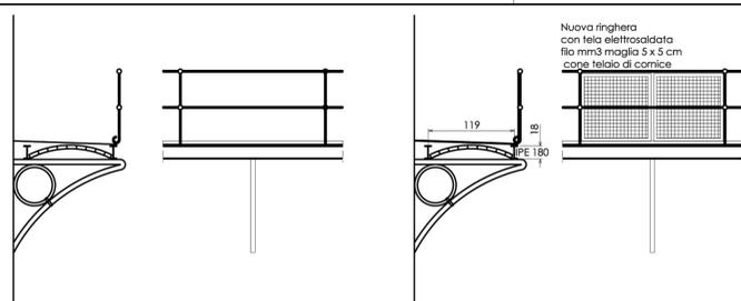
Sistemazione di passerelle in quota mediante consolidamento delle volte in mattoni ed integrazione delle strutture in acciaio armato. Previa rimozione parti collabenti e rifacimento pavimento in battuto di cemento sopra il bacino di scarico: voce così realizzata:
