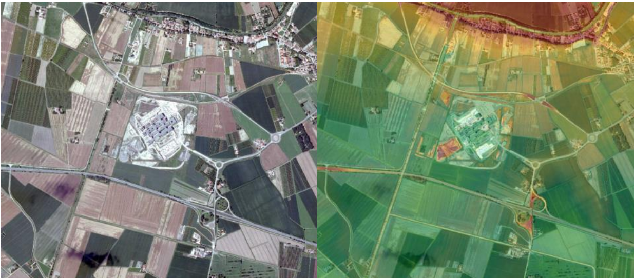
Nell'immagine di sinistra (anno 2008) è visibile l'Ospedale di Cona nella fase terminale della sua costruzione; nell'immagine di destra, la stessa area trasformata come dato di cartografia numerica in modello DTM Lidar 2008.
